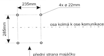
Rozteče upevňovacích otvorů
